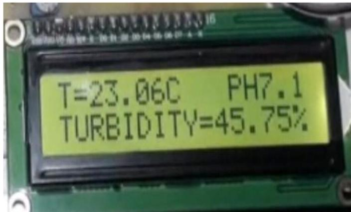
Fig. 5. LCD Display
