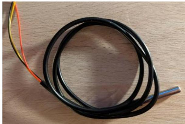
Fig. 3. DS18B20 Temperature Sensor
